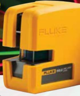
Construidas con la resistencia que espera de Fluke. Fabricados para sobrevivir a una caída de un metro de altura. Precisión de 6 mm a 30 metros (3 láseres de punto) y de 3 mm a 10 metros (2 láseres de línea). El cardan de autonivelación y de rápida instalación entrega marcas precisas casi al instante
